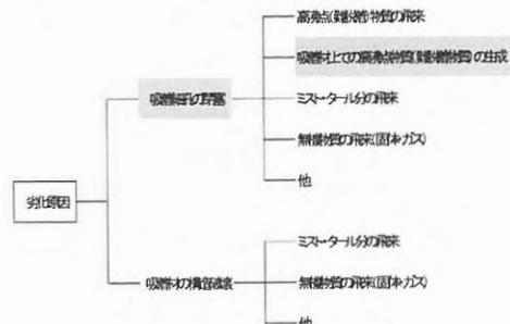
図8 吸着材劣化原因の分類
