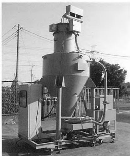
写真7 小型貯槽ユニット 設置例
