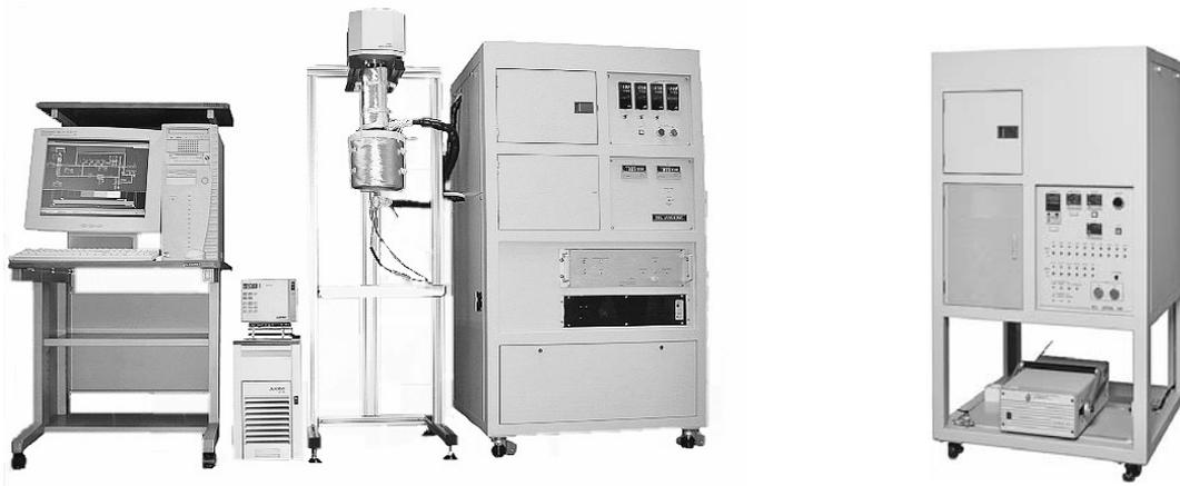
図8 BELSORP-BG (左) と BELSORP-VC (右) の外観写真
